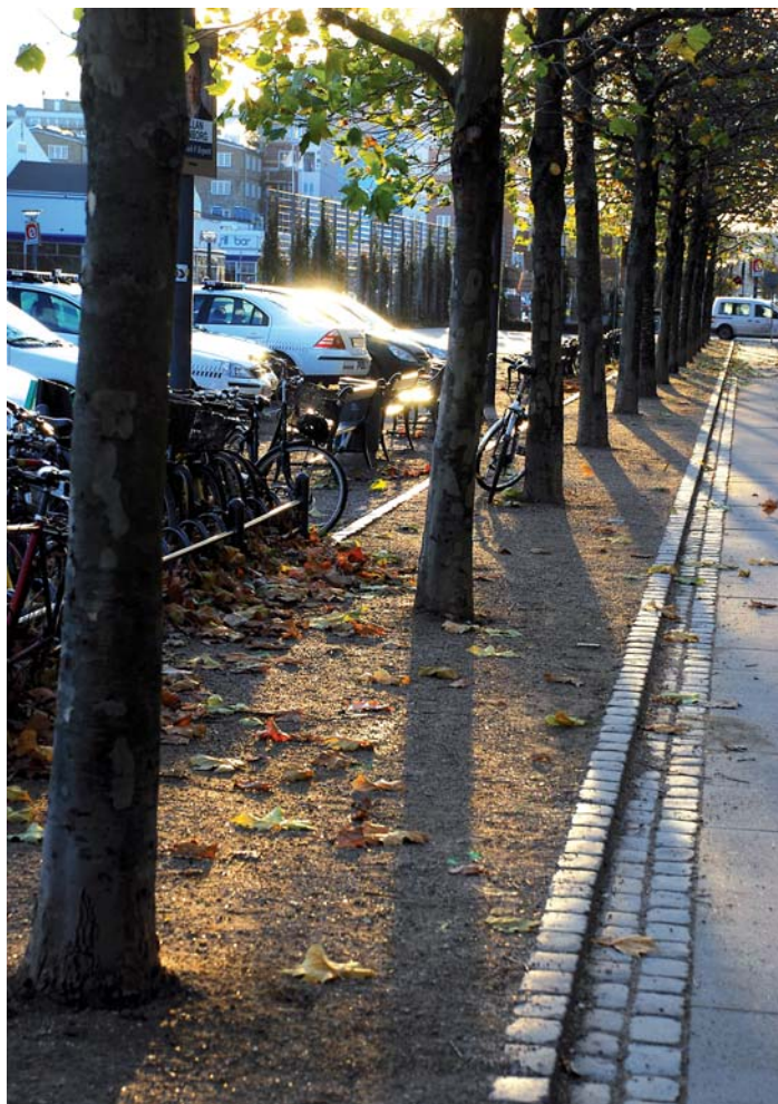
Københavns kommune har med succes brugt 'rodgrus' med meget højt sandindhold og derved med en høj bæreevne uden risiko for komprimering og blokering af ilt til de dybe rødder. Her Platan på Halmtorvet.
