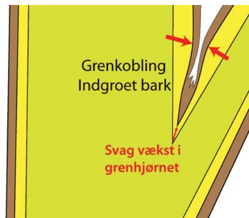
Figur 2: Barkspor er ældre bark som på grund af pladsmangel stødes udad. Hvis væksten i grenhjørnet ikke er kraftig nok, bliver grenhjørnet klemmt inde mellem stamme og gren og der dannes indgroet bark.
